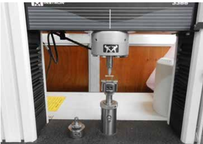
Figura 5. Máquina Universal de ensayo Instron modelo 3366
