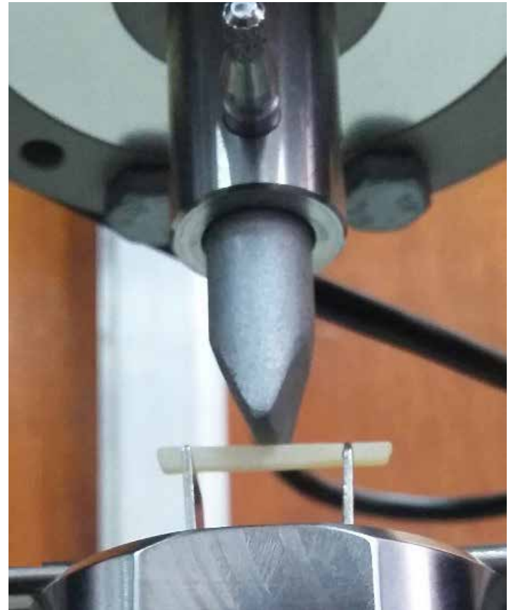
Figura 6. Prueba de ensayo de resistencia a la flexión
