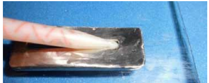
Figura 2. Molde metálico para confección de las unidades experimentales
