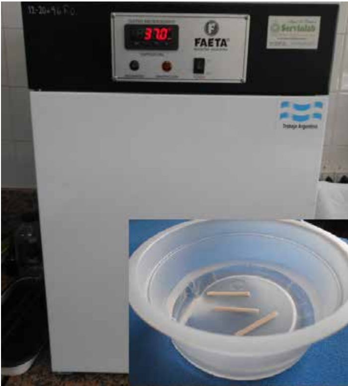
Figura 4. Especímenes en agua destilada en estufa a 37°.
