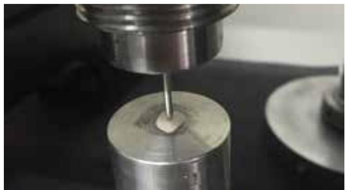
Figura 10- Test de push out
