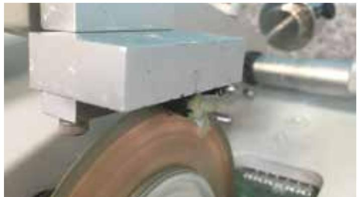
Figura 8- Corte del espécimen
