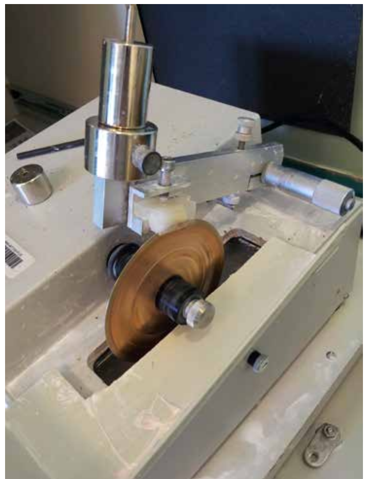
Imagen N4.- Recortadora Buehler Isomet
