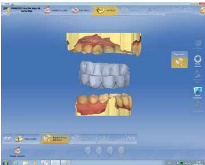
Figura N27.- En la pantalla modelo se observan los modelos virtuales como si hubieran pasado por la recortadora, en este fase del proceso se hace la relación entre el modelo de trabajo, el modelo antagonista y el registro de mordida.
