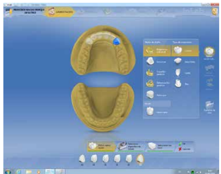
Figura N22.- Pantalla de administración, se hace la selección del tipo de restauración, modo de diseño y la pieza dental sobre la cual se fabricara la restauración, así como elegir el dispositivo de fresado y la selección del material en sus respectivas pantallas.
