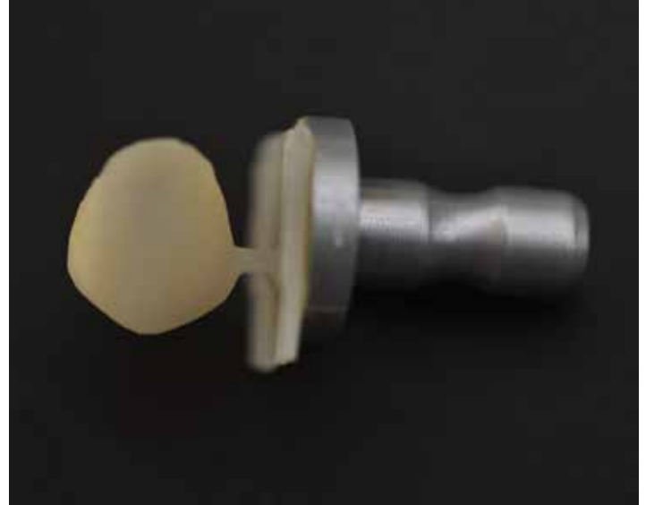
Figura N41.- Restauración fresada todavía unida al remante del bloque.
