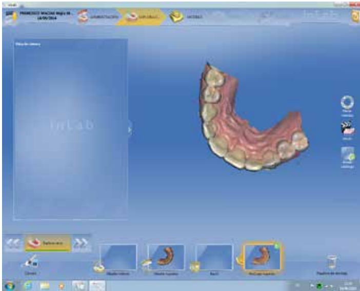
Figura N25.- Pantalla de exploración, es donde se hace la impresión digital del modelo de trabajo, del antagonista y el registro de mordida.
