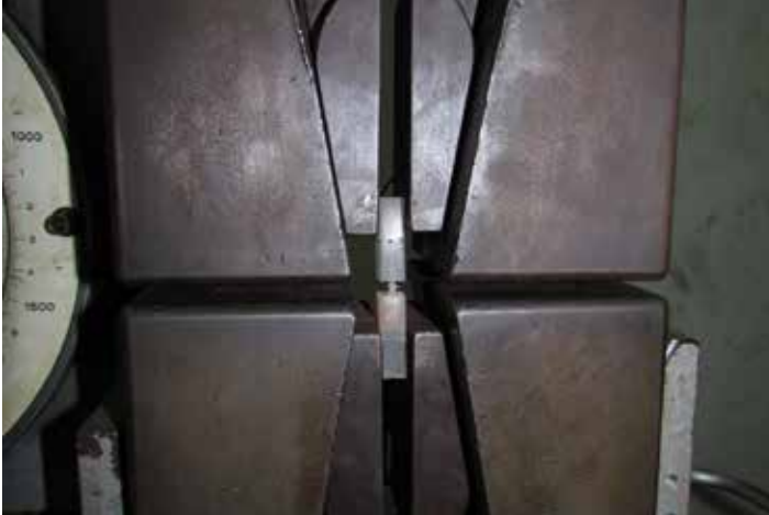
Figura 2. Cuerpo de prueba sometido a la tracción en la máquina de ensayos universales Amsler.
