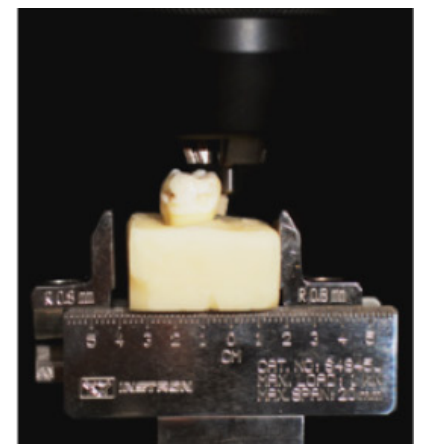
Figura 7. Se aplicó una fuerza de cizallamiento de 5 kN con una punta de 3 mm en el equipo INSTRON 3365 sobre el composite.
