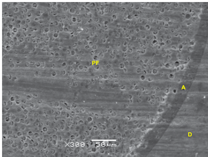
Figura N2.- Corte transversal a 300 X. Se aprecia perfecta integración entre el poste de fibra y la resina compuesta. Puede verse una banda negra que posiblemente corresponda a la capa de adhesivo. (A-adhesivo)
