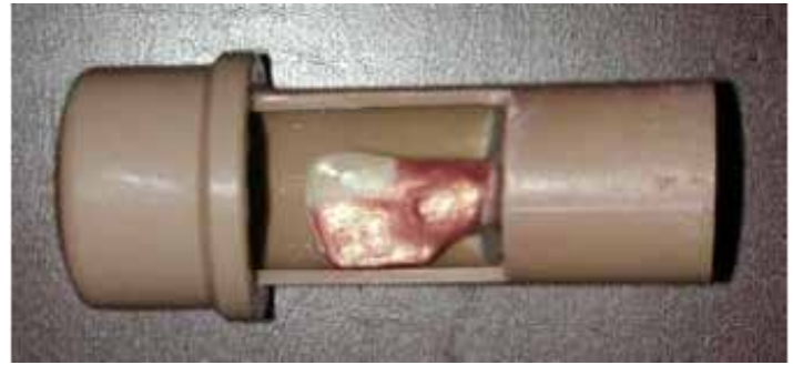
Figura N3.- Tubo de PVC con una de sus extremidades obturada con resina, material que a su vez sostenía el diente por la raíz. El conjunto fue sellado por medio de una tapa colocada en el extremo libre de resina.
